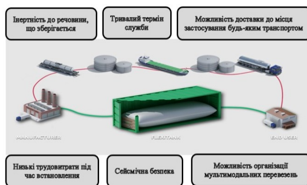
Рис. 6. Відмінні особливості флексі-танків для небезпечних вантажів
