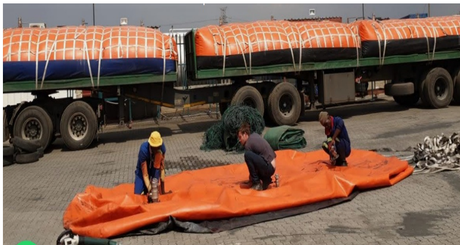
Рис. 4. Підготовка спеціального флексі-танку для транспортування дизельного палива
